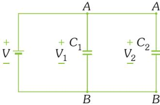
Se observa que la fuente de voltaje y los capacitores  $C_1$  y  $C_2$  se encuentran conectados a los terminales A y B; por consiguiente, se encuentran conectados en paralelo.
